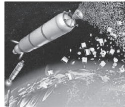
(나) 우주 안개 분무기: 우주 쓰레기 진행 방향에 안개를 뿌려 냉동시킨 후 궤도 이탈을 유도한다.
